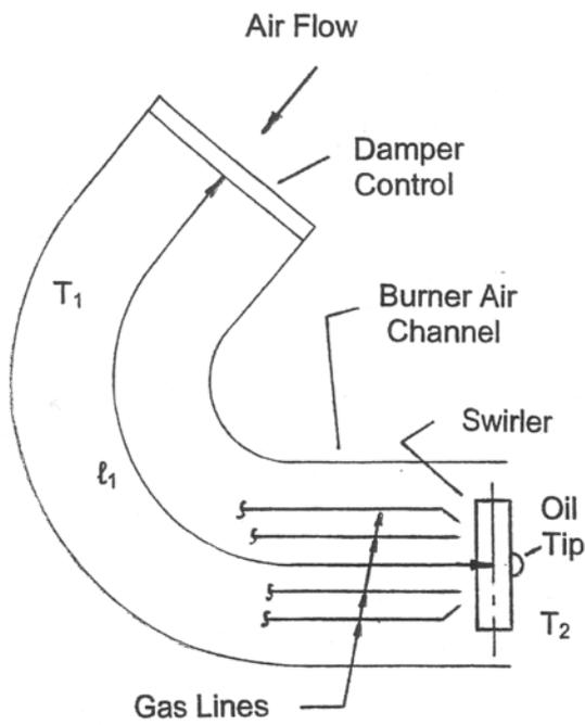
Fig. 2 Burner Arrangement ( schematic )
