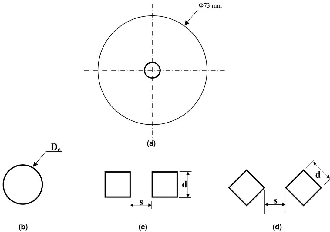
FIG.2 DISK NOZZLE CONFIGURATION; (a) DISK NOZZLE (b) EQUIVALENT SINGLE JET (c) EDGE FACED TWIN JET
