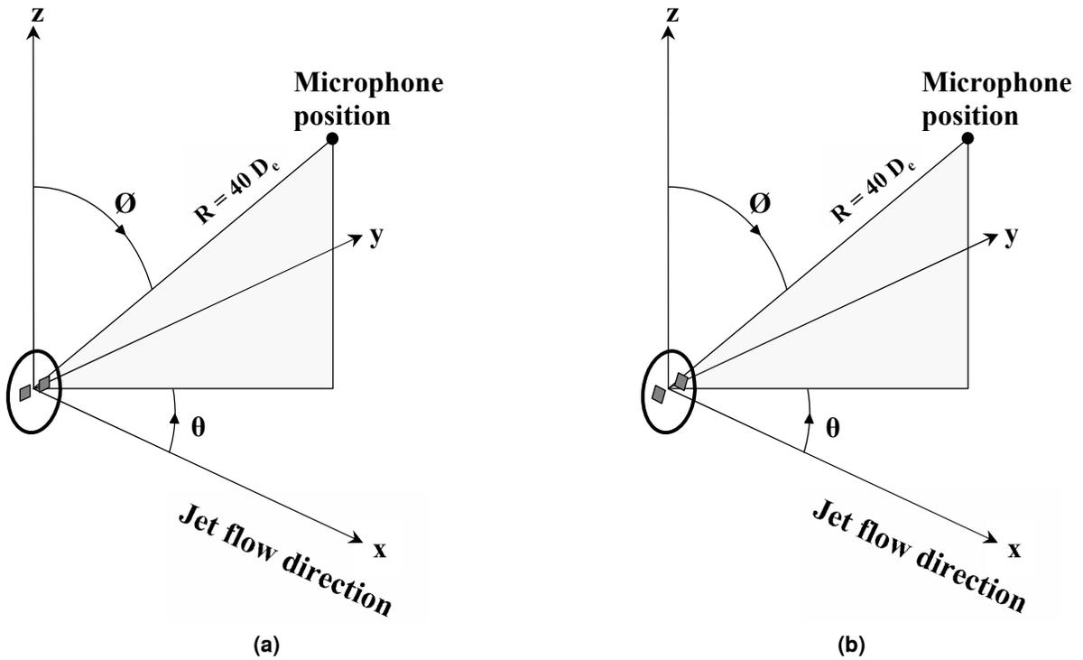
FIG.4 MICROPHONE POSITION IN THE FAR FIELD MEASUREMENT; (a) EDGE FACED TWIN JET
