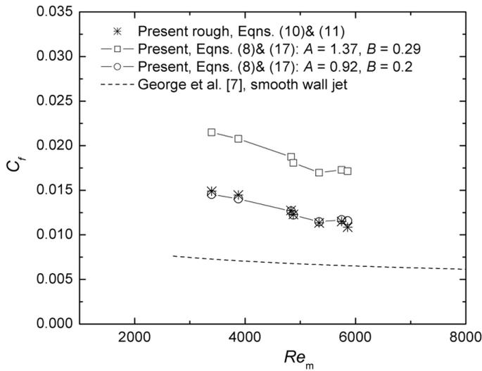
**FIGURE 5.** SKIN FRICTION COEFFICIENT FOR A ROUGH TURBULENT WALL JET.
