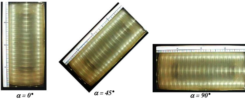
**Figure 7 :** Effect of inclination on the Taylor vortex  $Ta = 44,2$  pour  $\Gamma = 40$
