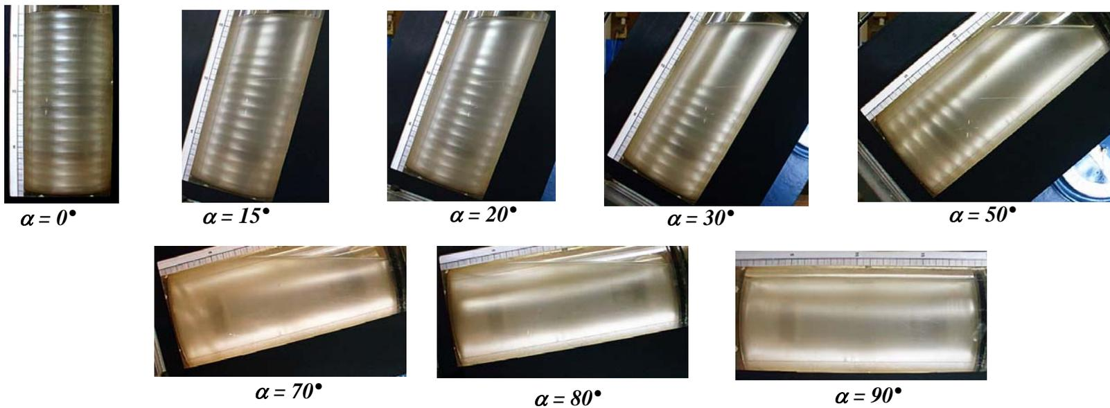
**Figure 9:** Effect of inclination  $\alpha$  on the Taylor vortex  $Ta = 46$  pour  $\Gamma=37$
